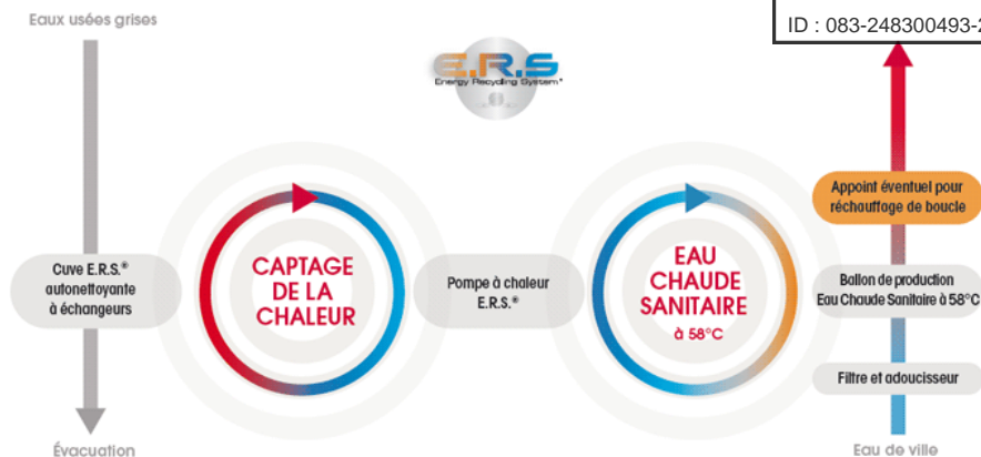
Figure 28 – Principe de fonctionnement de la PAC sur eaux grises – Source : Biofluides
